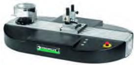
Моторизованное нагружающее устройство для калибровки № 7794-2
