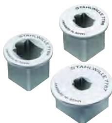
**Квадратные адаптеры** необходимые для использования измерительного диапазона датчиков включены в комплектацию; например, для датчика № 7728-100 (с внутренним квадратом 3/4") предлагаются адаптеры № 7787 (1/4" внутренний на 3/4" внешний), № 7788 (3/8" внутренний на 3/4" внешний) и № 7789 (1/2" внутренний на 3/4" внешний).
